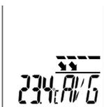
Moderne Max/Min/AVG relaterer til den infrarøde temperatur og angiver altid den maksimale, minimale eller gennemsnitlige infrarøde temperatur. Max/Min/AVG-værdierne bestemmes under den igangværende måling, når udløseren (9) holdes inde. Ved start af en ny måling, eller hvis man trykker på udløseren (9), slettes og genberegnes værdien.
