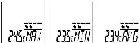
De modi Max./Min./AVG hebben betrekking op de infrarood-temperatuur en geven de maximale, minimale of gemiddelde infrarood-temperatuur weer. De Max./Min./AVG-waarden worden tijdens de lopende meting bij ingedrukte activeringstoets (9) bepaald. Bij de start van een nieuwe meting resp. door indrukken van de activeringstoets (9) wordt de waarde gewist en opnieuw berekend.
