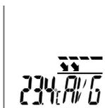
Die Modi Max/Min/AVG beziehen sich auf die Infrarot-Temperatur und zeigen jeweils die Maximal-, Minimal- oder Durchschnitts-Infrarot-Temperatur an. Die Max/Min/AVG-Werte werden während der laufenden Messung bei gedrücktem Auslöser (9) ermittelt. Bei Start einer neuen Messung bzw. durch Drücken des Auslösers (9) wird der Wert gelöscht und neu berechnet.
