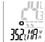
**!** Min-/Max-værdierne slettes ved modusskift, og når apparatet tændes/slukkes.
