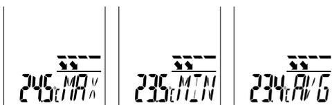
Les modes max./min./moy. se basent sur la température infrarouge et indiquent respectivement la température par infrarouge maximale, minimale ou moyenne. Les valeurs max./min./moy. sont calculées pendant la mesure en cours lorsque l'on appuie sur la touche de déclenchement (9). La valeur est supprimée et à nouveau calculée lorsqu'une nouvelle mesure est lancée ou en appuyant sur la touche de déclenchement (9).
