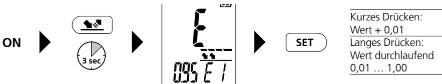
Die Speicherplätze E 1 - E 5 können beliebig verändert werden. Durch langes Drücken auf den Speicherplatz kann dieser angepasst werden und bleibt abgespeichert. Durch Rücksetzen der Werkseinstellungen werden die Werte wieder auf 0,95 / 0,85 / 0,75 / 0,65 und 0,55 gesetzt.
