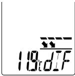
Ce mode se base sur la température par infrarouge et calcule la différence entre la température par infrarouge maximale et la température par infrarouge minimale d'une mesure en cours. La valeur est supprimée et à nouveau calculée lorsqu'une nouvelle mesure est lancée ou en appuyant sur la touche de déclenchement (9).
