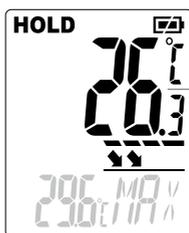
Anzeige der Infrarot-Temperatur (in jedem Messmodus)
