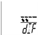
4. Différence température infrarouge (max. / min.)
