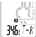
Das Gerät schaltet automatisch in den Kontakt-Temperaturmodus T-K sobald ein Temperaturfühler (K-Typ) angeschlossen wird. Während der Temperaturfühler angeschlossen ist, schaltet sich das Gerät bei einer Batterieladung von mindestens 15% nicht automatisch ab.
