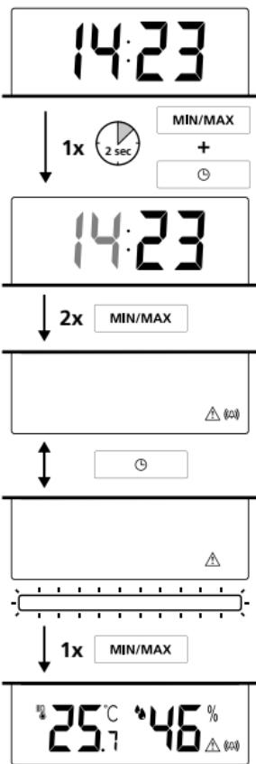
! Como advertencia de la humedad del aire se puede ajustar en el menú una alarma acústica, una alarma visual o una combinación de ambas. Cuando los valores de humedad del aire se mantienen elevados o bajos de forma permanente, se muestra en la pantalla el símbolo de alarma y una advertencia visual y/o acústica periódica. La alarma no se emite de forma permanente para ahorrar energía y evitar errores.
