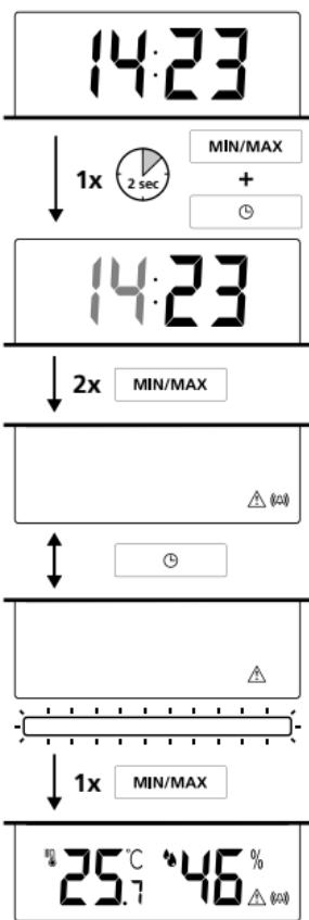
! O aviso de humidade do ar pode ser configurado no menu como alarme acústico, alarme visual ou uma combinação de ambos. No caso de valores permanentemente altos ou baixos de humidade do ar, o símbolo de alarme aparece no visor e é dado um aviso visual e/ou acústico em certos intervalos. Para poupar energia e para evitar avarias, o alarme não é emitido permanentemente.
