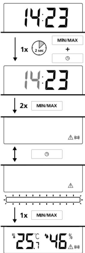
! Dans le menu, il est possible de régler l'avertissement en cas d'humidité de l'air anormale sous forme d'alarme sonore, d'alarme visuelle ou de combinaison des deux types d'alarme. En cas de valeurs en permanence élevées ou basses de l'humidité de l'air, le symbole d'alarme s'affiche à l'écran et un avertissement visuel et/ou sonore a lieu à certains intervalles. L'alarme n'est pas émise en permanence pour faire des économies d'énergie et pour éviter des perturbations.
